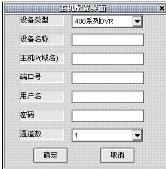
在此界面中，需选择添加的类型（根据要添加的设备选择相应的类型），输入设备名称（用户可随意命名），设备的IP或域名，设备的端口号，用户名，密码和通道数。添加完成后，在设备列表中出现刚刚添加的设备信息。
