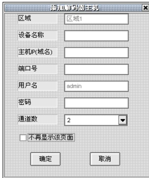
用户也可在主界面中，点击“系统配置”进入解码器配置界面添加解码器。
